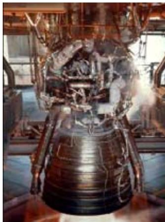
Bild 24: Vulcain-Triebwerk bei Qualifikationstests in Vernon (1993)
