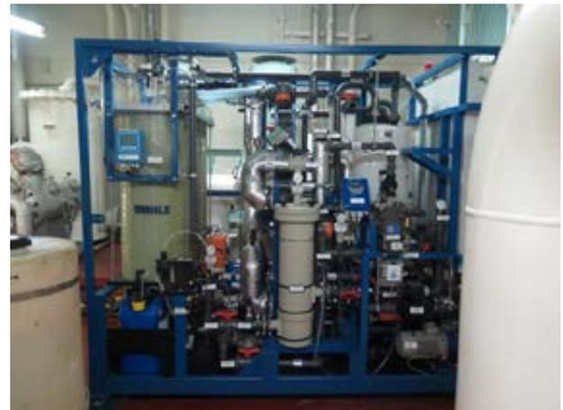
Bild 2: Membrandestillationsanlage der MAHLE Industriefiltration GmbH (Quelle: T. Mann, Privat)
