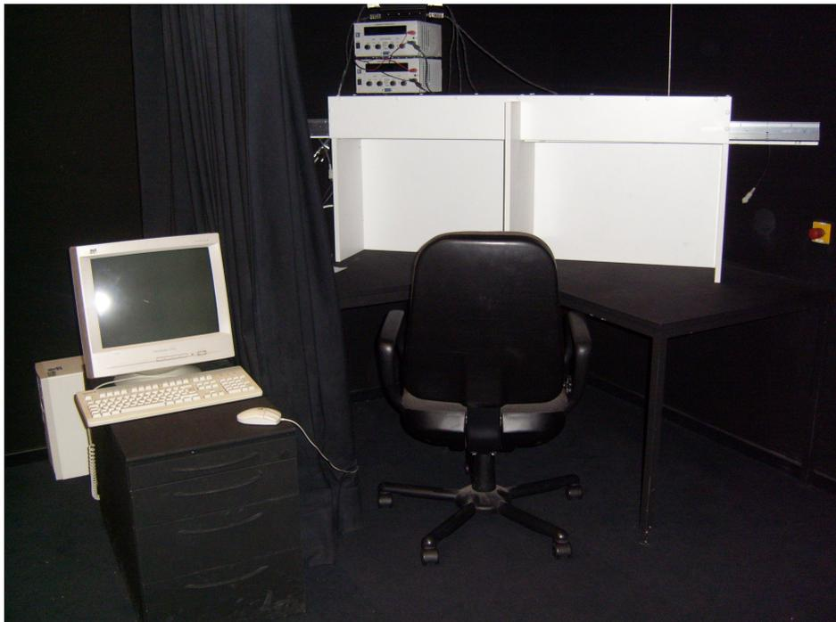
*Abb. 1:* Die Messanlage besteht aus dem Steuercomputer (links), einem herkömmlichen Desktop-Computer mit Linux-Betriebssystem, und einem weiss beschichteten, aus Spanplatten gefertigten zweiteiligen Aufbau (rechts). Durch eine Trennplatte separiert beleuchten zwei mit RGB-Dioden versehene Leuchten die jeweiligen Rückwände. Der zeitliche Verlauf und die Farbe der Beleuchtung werden durch den Rechner gesteuert.
